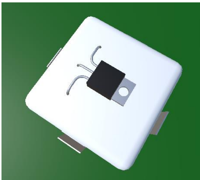
Obrázok 12 - Model súčiastky tranzistoru v trojrozmernom spracovaní
