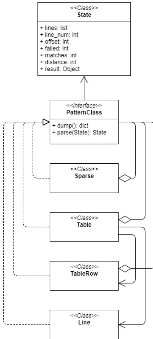
Obr. 21: Diagram tried zobrazujúci závislosti medzi triedami reprezentujúcimi vzor štruktúry pokladničného bločku.
