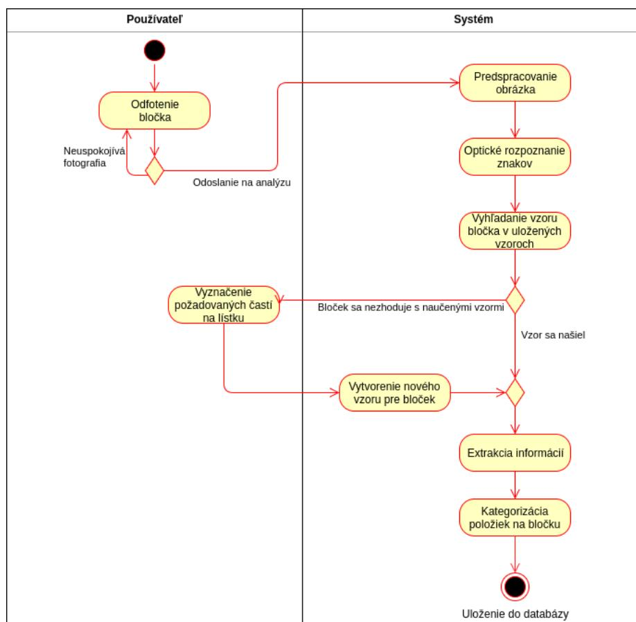
Obr. 20: Proces spracovania blokového dokladu v platforme KillBills
