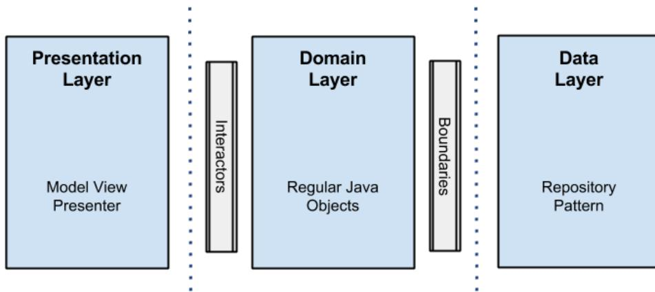
Obr. 23: Základná schéma architektúry. "Boundaries" a "Interactors" sú jediným spôsobom komunikácie medzi jednotlivými vrstvami. Ideálne by všetky ostatné moduly mali komunikovať výhradne cez doménovú vrstvu
