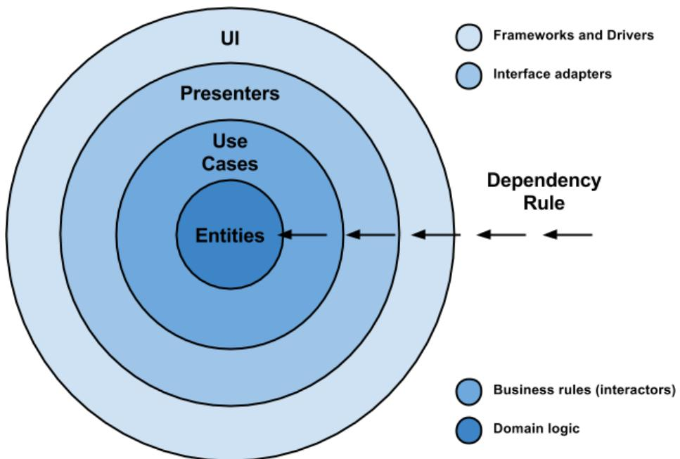
Obr. 22: Schéma závislostí medzi vrstvami. Vnútorné vrstvy by nemali vedieť o existencii vyšších vrstiev.
