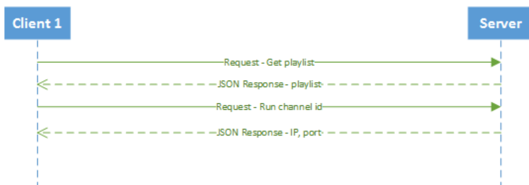
Obr.4.5: Diagram toku správ počas spustenia streamu
