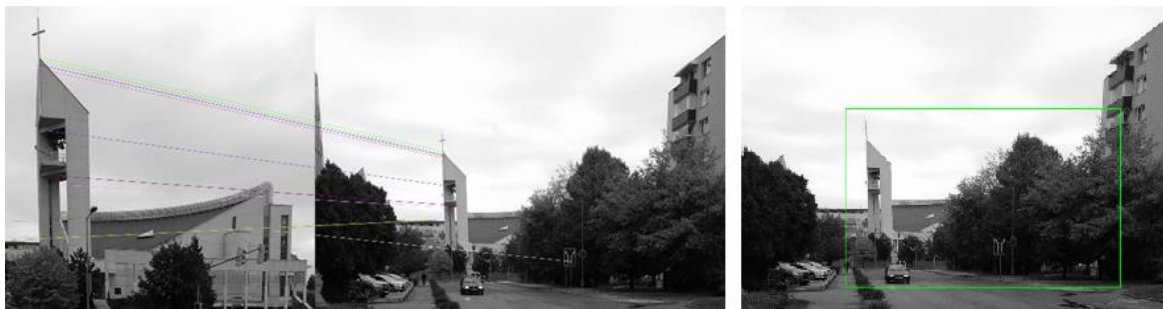
Obrázok 3. Detekcia objektu pomocou deskriptorov a určenie jeho polohy s využitím homografie.
