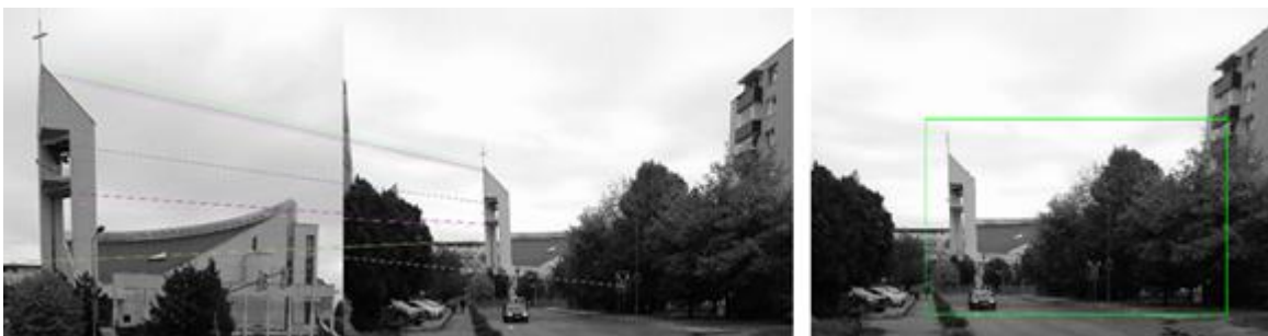
Obr 3. Detekcia objektu pomocou deskriptorov a určenie jeho polohy s využitím homografie.
