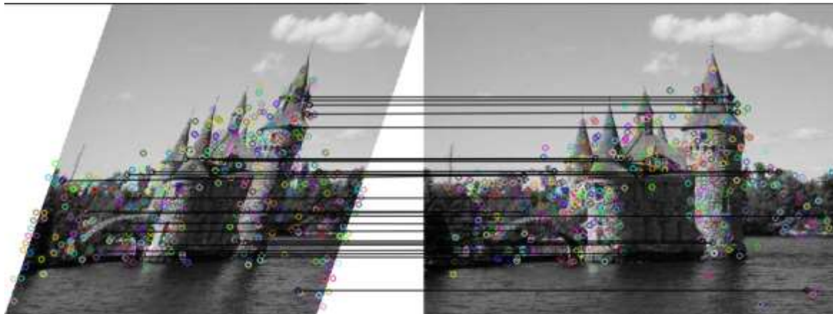
Obr. 4. Nájdené zhody medzi 2 obrázkami (1. obrázok je zdeformovaný)
