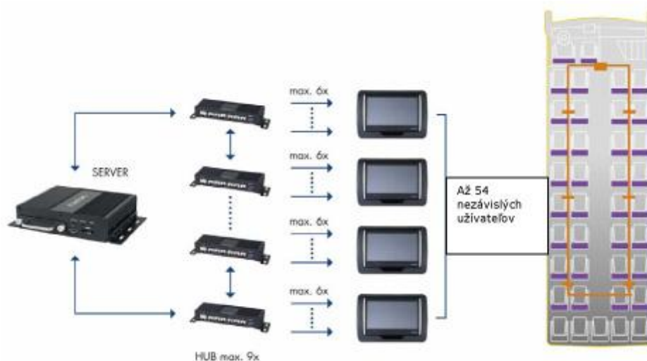
Obr. 2: Architektúra zapojenia digitálneho MOD systému
