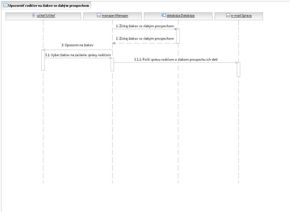
Obrázok č. 29: Sekvenčný diagram pre prípad použitia Upozorniť rodičov na žiakov so slabým prospechom
