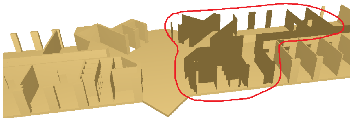
Obr. 50 Chybné zobrazenie modelu v O3D – priehľadné steny
