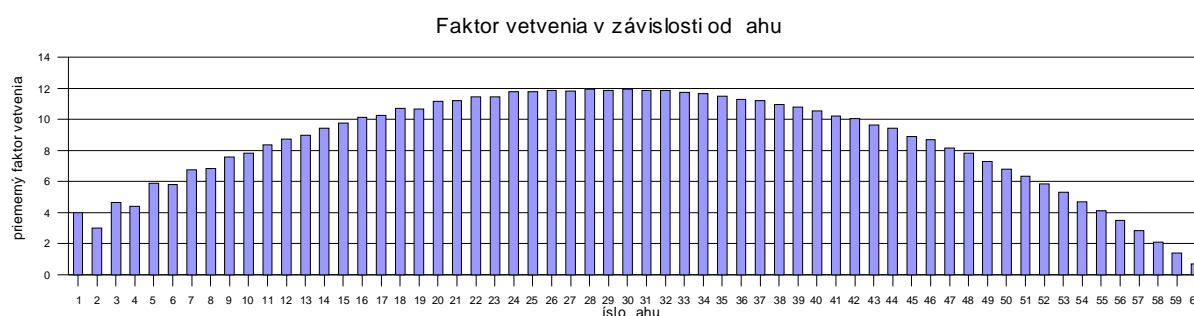
Obr. 35: Graf závislosti faktoru vetvenia od čísla ťahu
