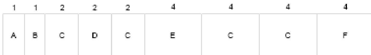
Obrázok č. 10: Formát dátovej časti IP - RIP paketu
